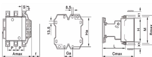
Рисунок 4. Габаритные и установочные размеры контакторов серии КМ-102 400-500А, мм.
