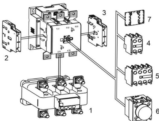
Рисунок 1. Контактор КМ-102 и схематичная установка аксессуаров
